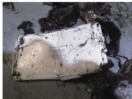
火災発生後のリチウムイオン電池
