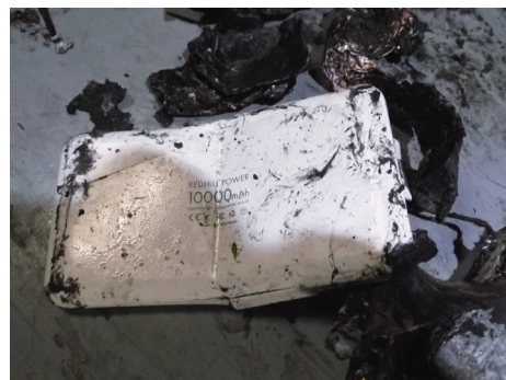
火災発生後のリチウムイオン電池
